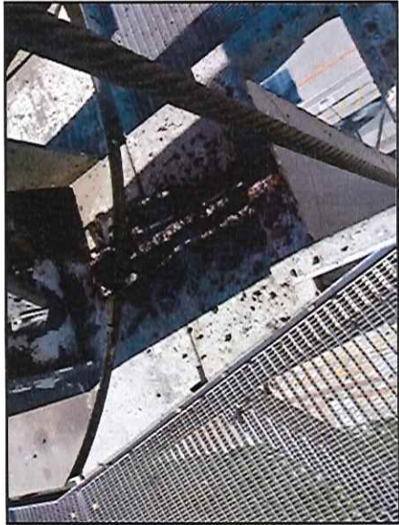
Local: Torre Item # 46: excesso de graxa nas polias fixas da torre do guindaste.
