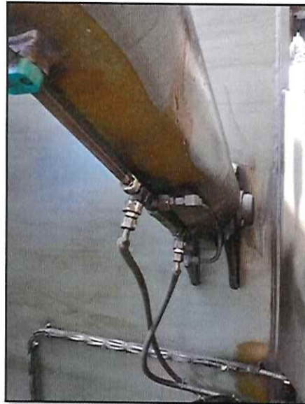
Local: Estrutura Rodante Item # 01: Pequeno vazamento de óleo nas conexões do braço articulado da patola #02.
