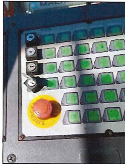
Local: Cabine Item # 61: no painel da cabine, a chave de ligar o equipamento está solta.
